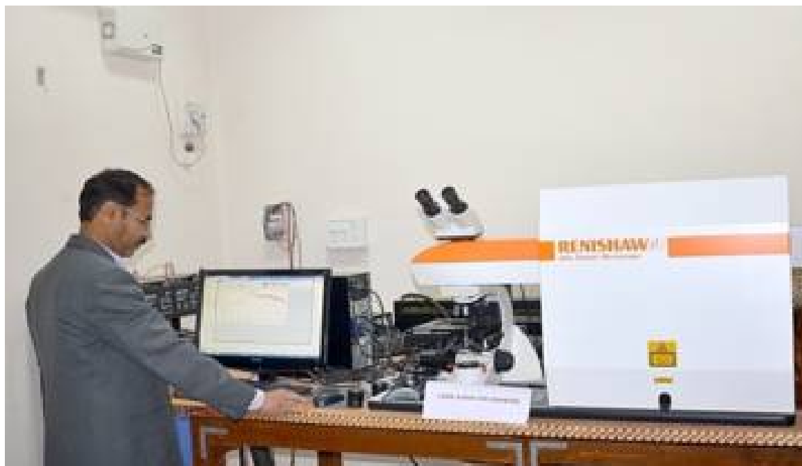
सॉफिस्टिकेटेड इंस्ट्रुमेंटेशन सेन्टर के अन्तर्गत लेजर रमन माईक्रोस्कोप Laser Raman Microscope facility at Sophisticated Instrumentation Centre (SIC)
